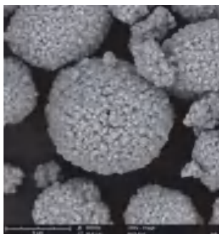
三元材料--未喷金直接观测 10,000倍下, 不喷金仍能清晰 分辨三元材料的表面形态
